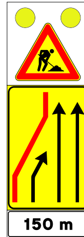
Figura 399/a Art. 39 Presegnale di cantiere mobile
