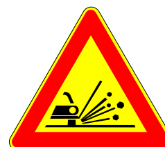
Figura 390 Art. 31 Materiale instabile sulla strada
