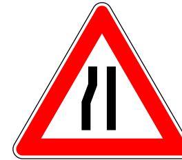
Figura 18 Art. 90 Strettoia simmetrica a sinistra
