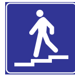
Figura 306 Art. 135 Sottopassaggio pedonale
