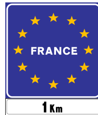
Figura 97/b Art. 123 Preavviso di confine di stato tra paesi della comunità europea
